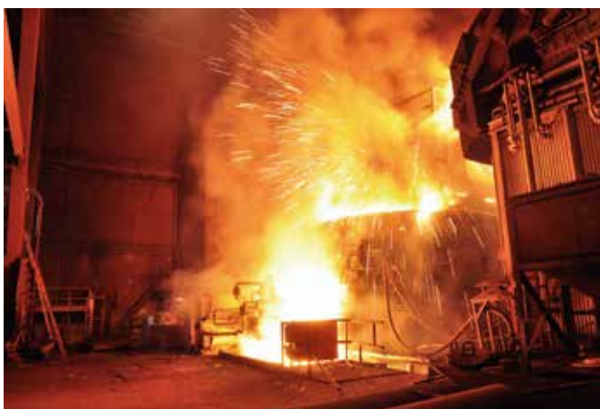
Recyclage de ferrailles d'acier au four à l'arc électrique
